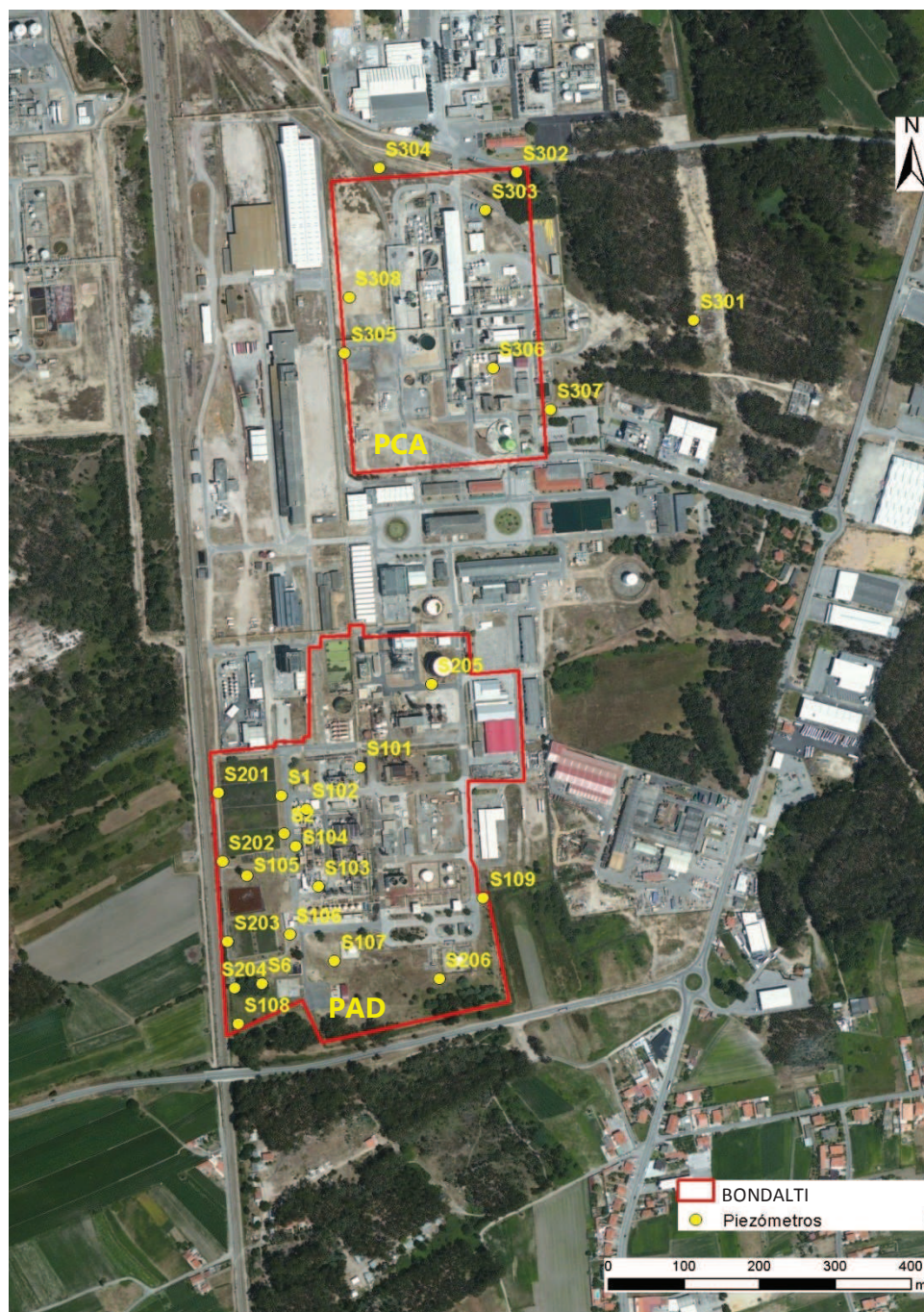
Figura 3.1 - Localização aproximada dos piezômetros na rede de monitorização do nível piezométrico e da qualidade da água subterrânea na área fabril da BONDALTI – setor PAD e PCA.
